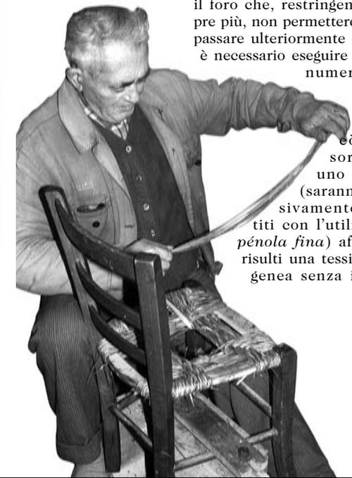
**4 Uso del caécio.** Giunto quasi al termine del lavoro, *el careghéta* usa *el caécio* per tenere aperto il foro che, restringendosi sempre più, non permetterebbe di far passare ulteriormente il *còrdolo*; è necessario eseguire il più alto numero di giri possibile, anche se i *còrdoli* si sormontano uno sull'altro (saranno successivamente appiattiti con l'utilizzo della *pénola fina*) affinché ne risulti una tessitura omogenea senza interstizi.
